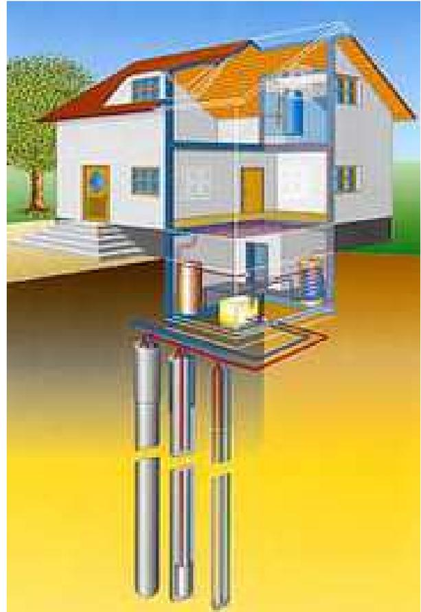
**Figura 26.** Schema di un impianto geotermico a bassa entalpia con le relative sonde geotermiche.
