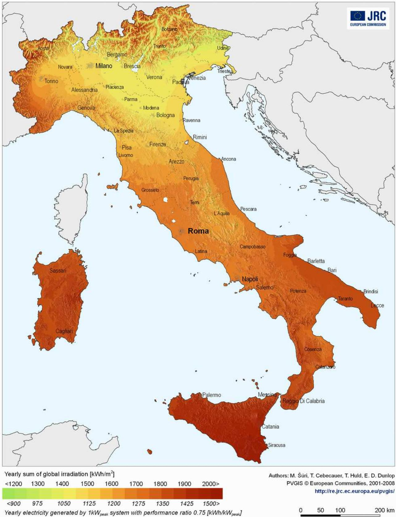
Figura 20. Energia generata da 1 kWp di fotovoltaico con inclinazione ottimale in Italia.
